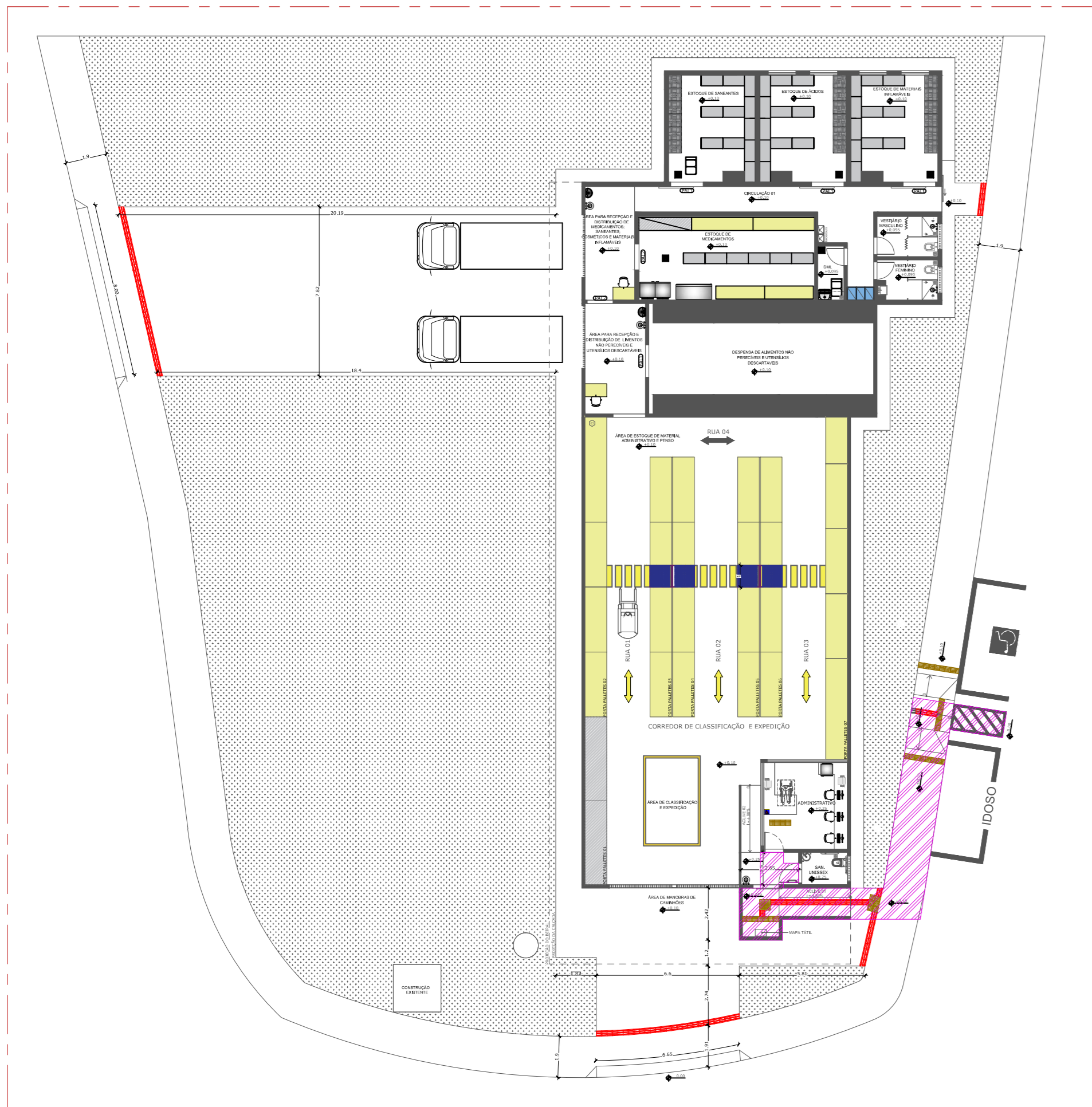
PLANTA DE IDENTIFICAÇÃO DE ROTA ACESSÍVEL Esc.: 1/200
